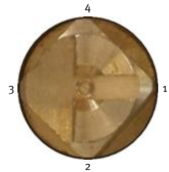
Vierkant-Positionsbezeichnungen (Vierkant ist auf Position 1 gestellt)
